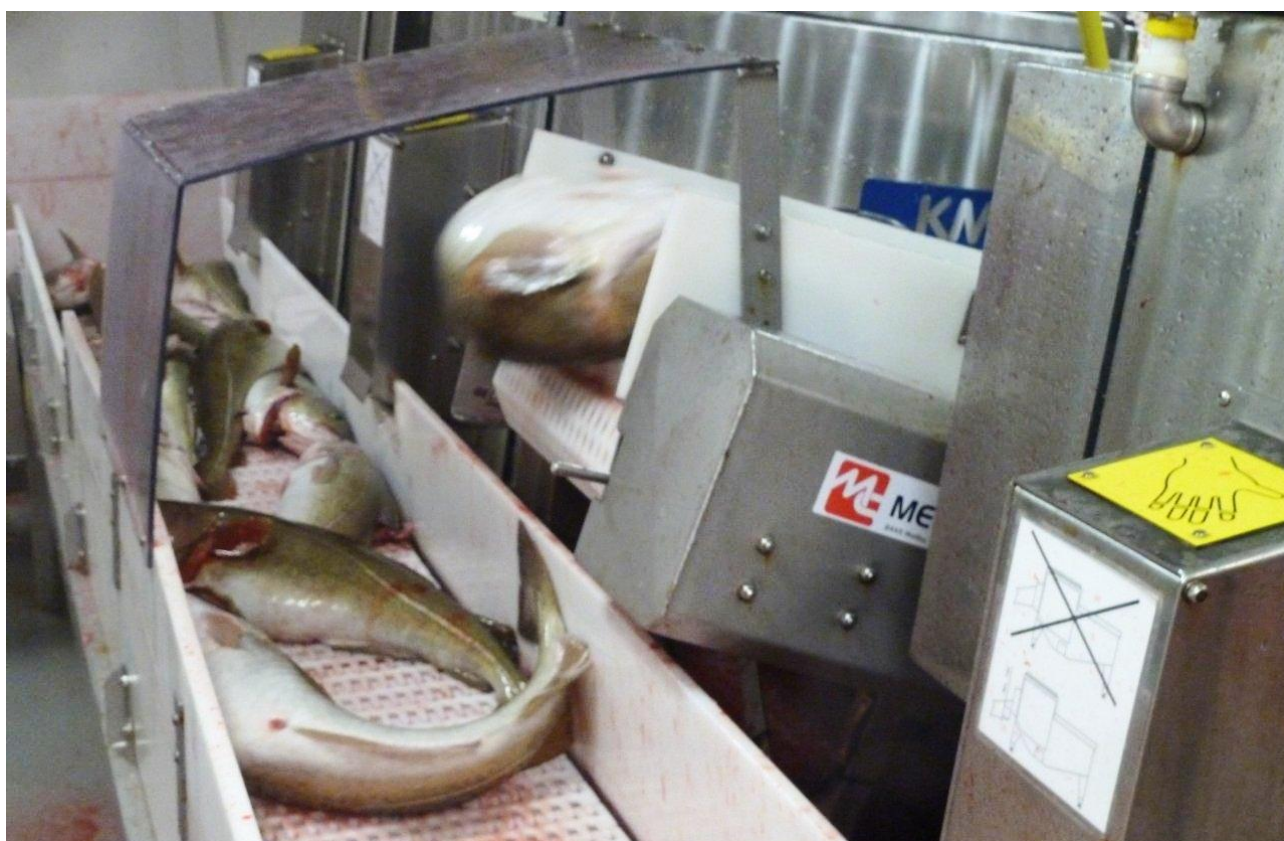
Bilde 17 Sløyemaskiner av typen KM er plassert tverrskips på fabrikkdekket.
