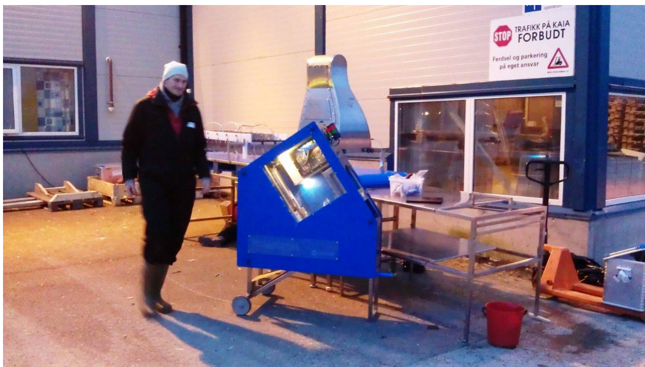
Bilde 4 EI-bedøver, skanner og bløggemaskin montert utfor Prestfjords fryselager i Myre havn.
