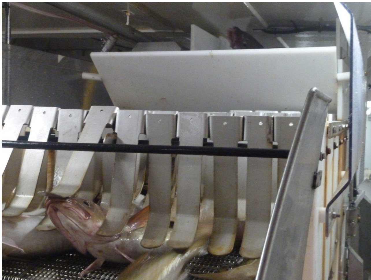
Bilde 13 Elektro-bedøver plassert på fabrikkdekket ombord på MS "Meløyfjord".
