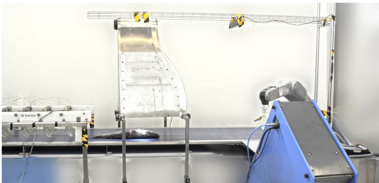
Figur 1 Arrangement for el-bedøving og bløgging av torskefisk.
