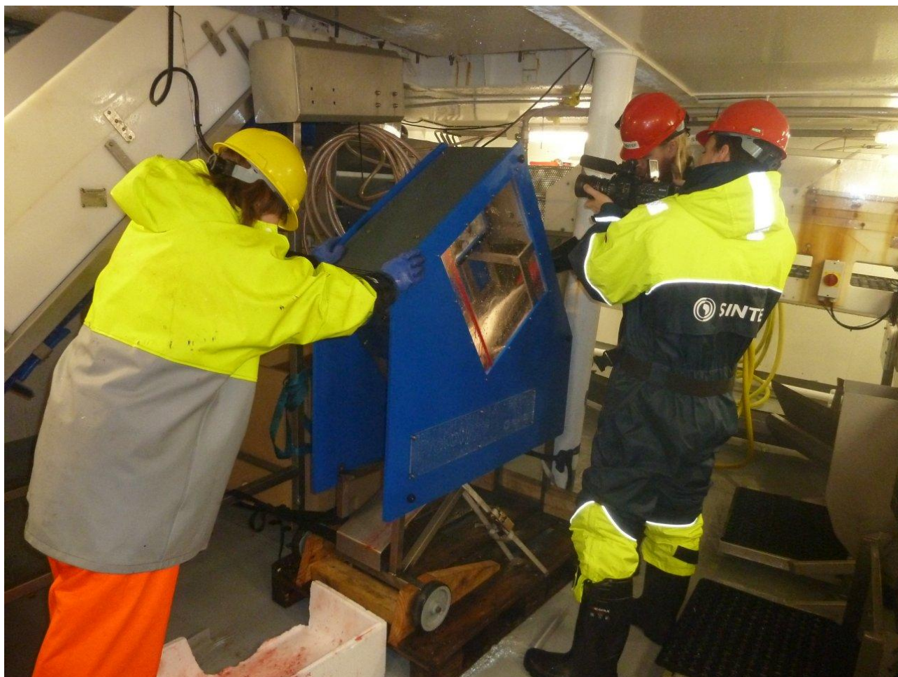
Bilde 15 Bløggemaskin under testing ombord på MS "Meløyfjord".
