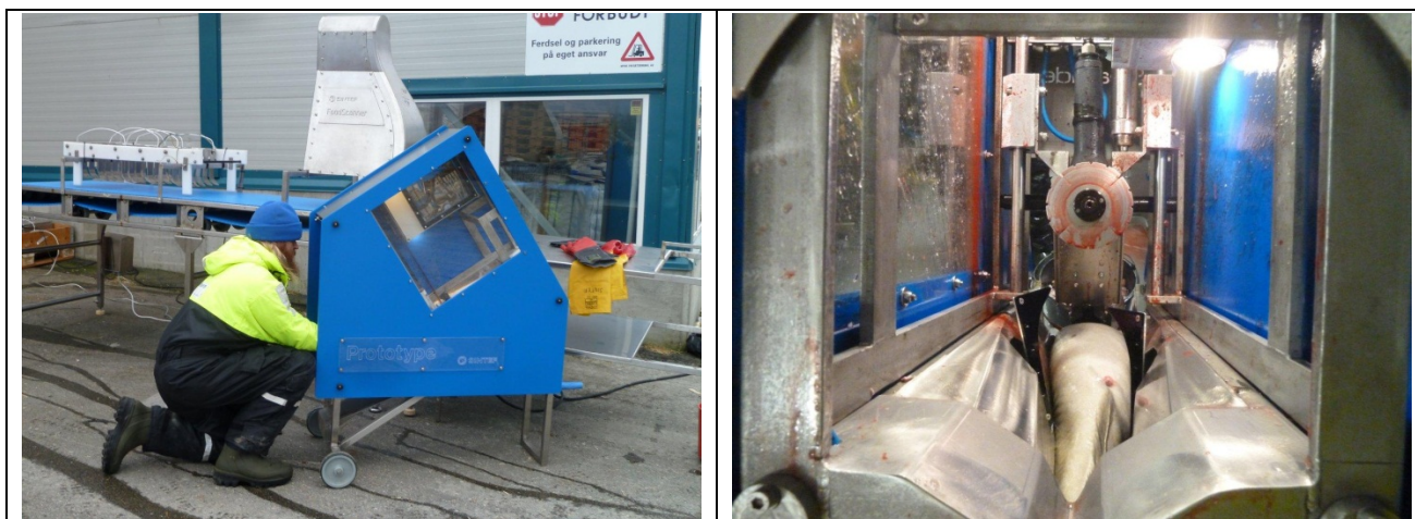
Bilde 1 Prototypen bløggemaskin tilordnes i Myre havn og under bruk på fartøy
