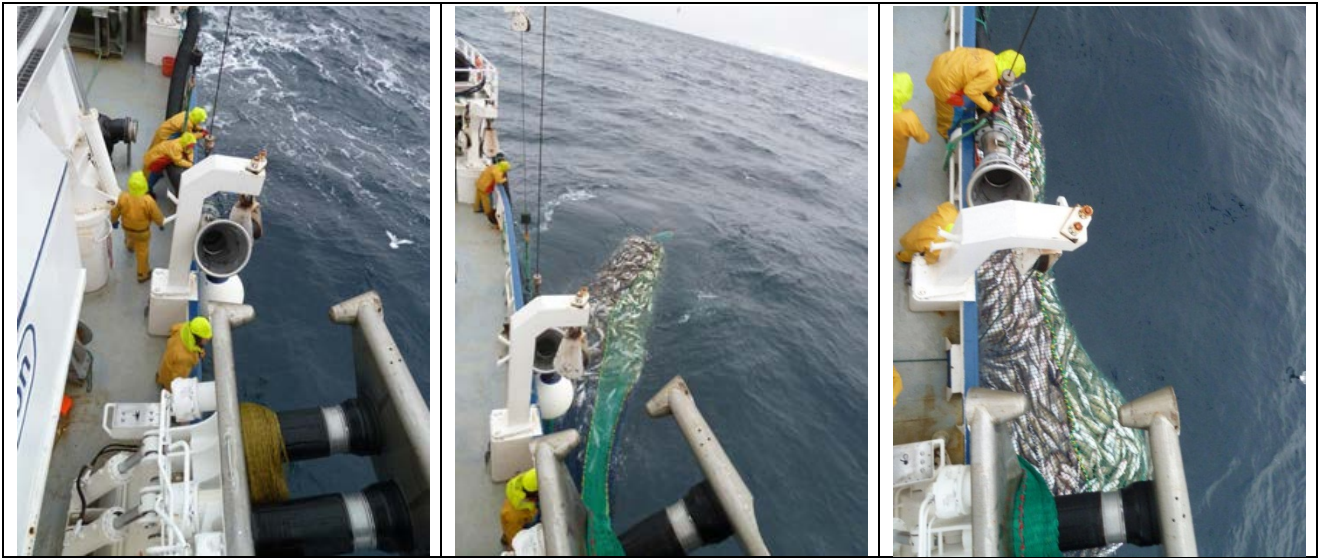
Bilde 11 Snurrevadnota er oppe og fangstsekken tas inn til skutesiden for på-kopling av sugeslagen.
