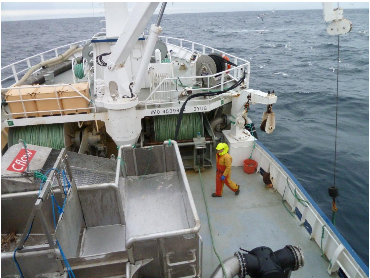
Bilde 12 Sugelagen er koplet opp til trålsekken og fiskerne kan forlate fangstdekket.
