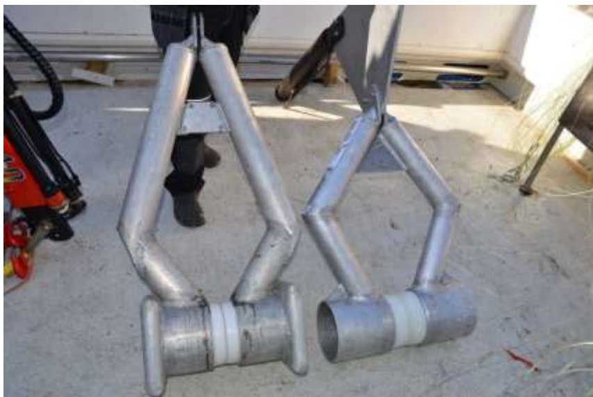
Bilde 2. Den originale gjennomføringen til Sunnvald Brinchmann til venstre og den nye gjennomføringen laget av Hillesøy Mekaniske Verksted AS som ble laget med justerbar brems til høyre, begge laget i aluminium (Nordheim 2013).
