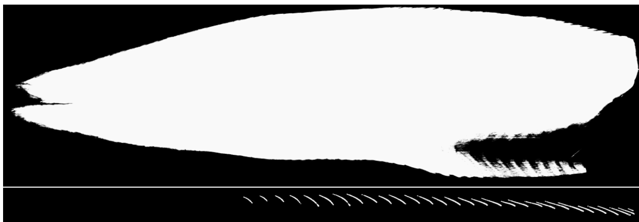
Figur 4-8; Prosessert bilde av røntgenbilde (Bilde 4-6), venstrefilet med lengde 53,5 cm.
