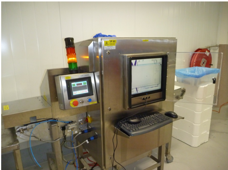
Bilde 4-5; InnospeXions røntgenmaskin satt opp og klargjort for testkjøring ved SalMars produksjonslinje.
