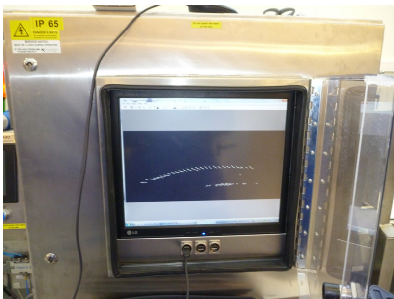
Bilde 3-5; Røntgenmaskin HYMCIS037 fra InnospeXion ApS, til bruk for utforskning av røntgenavbildning av laksefilet
