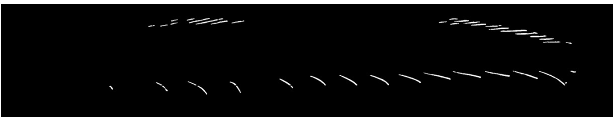
Figur 4-15; Prosessbilde av post-rigor laksefilet som viser 15 restpinnebein og ca. 16 "falske" bein.
