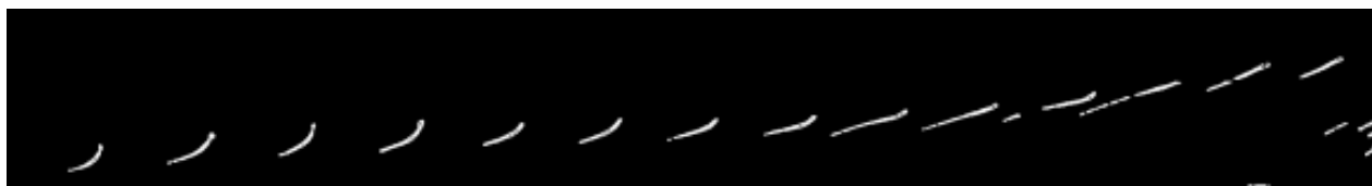
Figur 4-9; Prosessert bilde av det forrige røntgenbilde med 14 restpinnebein.
