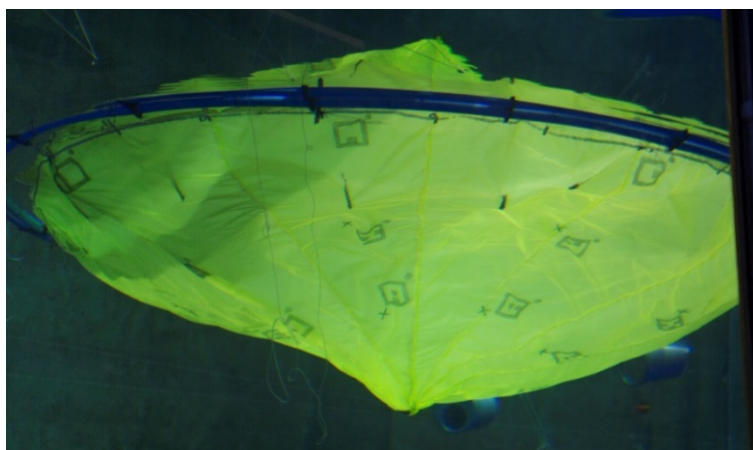
Figur 8: Kinahatt satt ved 8,2 cm/s strøm før reduksjon. Selv etter reduksjonen ble ikke duken helt fylt.
