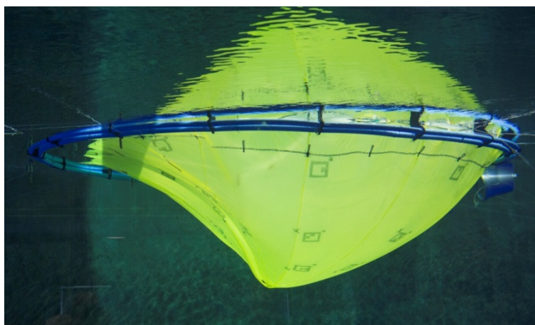
Figur 9: Kinahattduken går ned i bakkant (høyre i bildet). Bildet er tatt ved en strømhastighet på 61,8 cm/s
