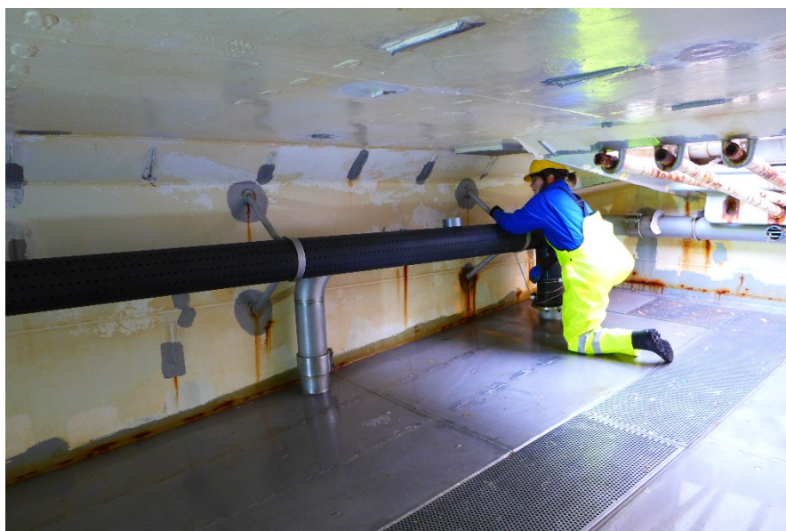
Figur 5. Venstre: Levendefisktanker ombord Molnes. Temperatur- og oksygenloggere ble festet langs det svarte røret som vises på bildet. Det svarte røret sørget for vanntilførsel. Foto: Guro Møen Tveit, SINTEF. Høyre: Elektrobedøver (STANSAS #1). Foto: Hanne Digre, SINTEF.
