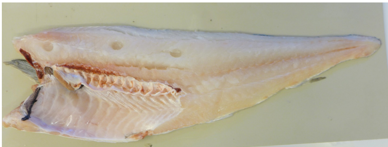
Figur 12. Nedtrykk ved lokasjon 1-3 (hull i loinsdelen) ved teksturmåling av høyre filet. Foto: Guro Møen Tveit, SINTEF.
