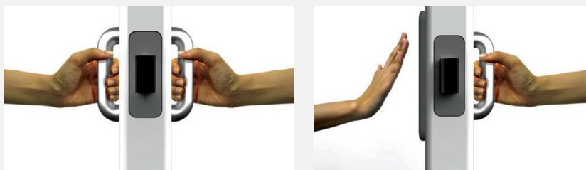
Figur 10. Til venstre vises utformingen på en dør som mange vil bruke feil og til høyre en dør som vil åpnes uten at brukeren gjør feil. (illustrasjoner: www.doctordisruption.com ).
