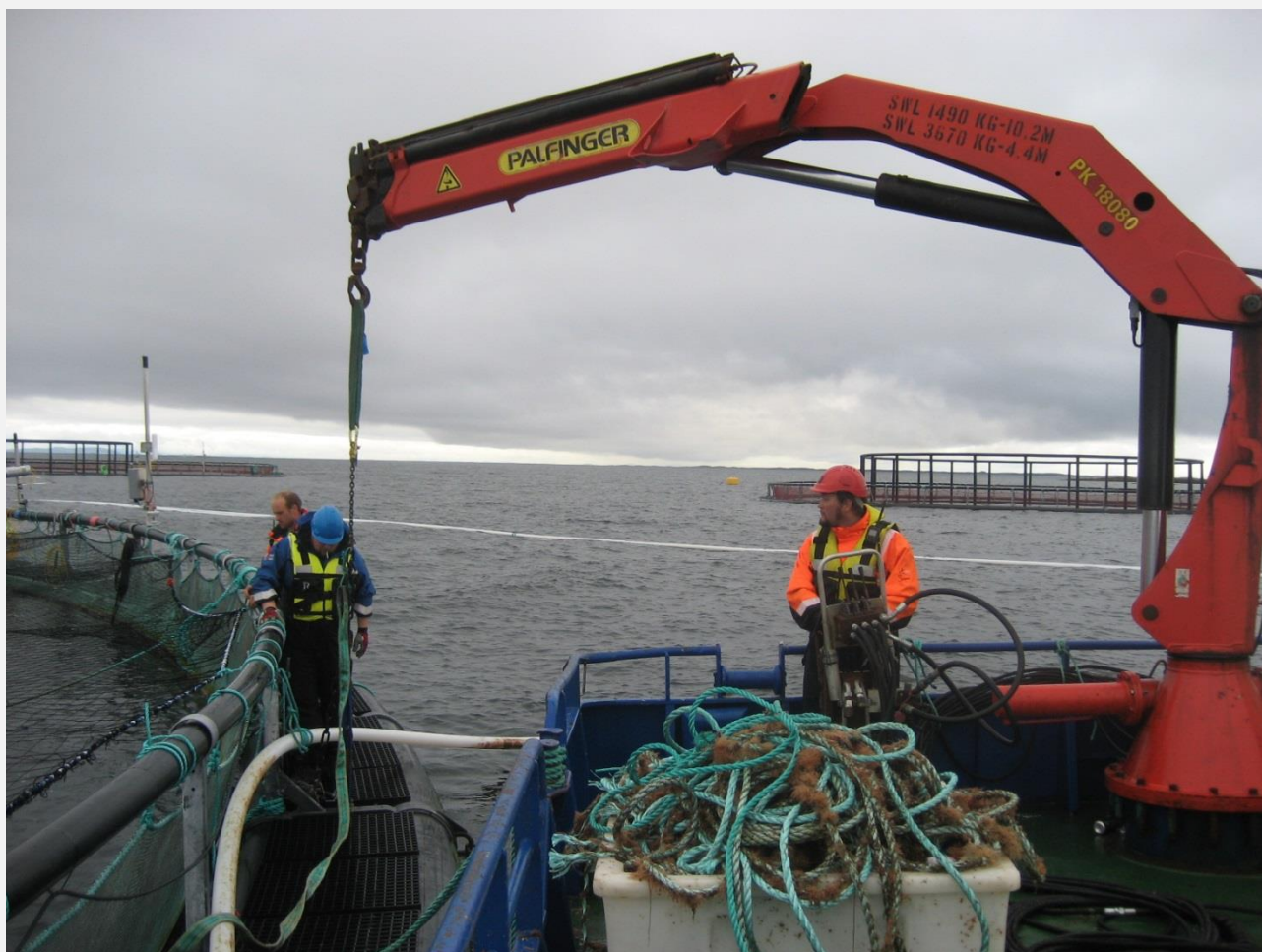
Figur 23. Bruk av kran gjør at man kan gjøre tunge løft med et minimum av fysisk anstrengelse (Foto: Trine Thorvaldsen, SINTEF).
