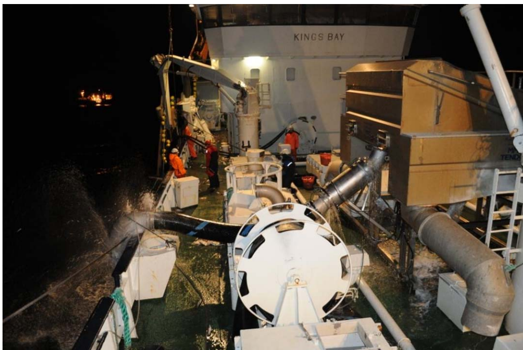
Bilde V1.3: Øverst: Silda i nota, kast 1, tokt I. Oppkopling av slangen til vakuumpumpen. Nederst: Ombordpumping av fisk ved hjelp av sentrifugalpumpen.
