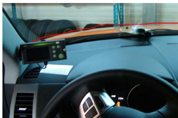
Figur 3: Bilde tatt under montering av en ISA-enhet på A-stolpen i ett av Statens vegvesens kjøretøy
