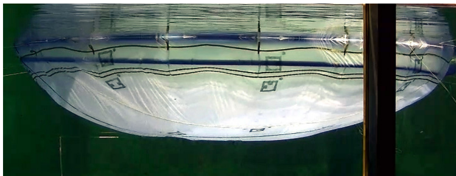
Figur 7. Muffinduken med merking. Merkingen er forskjellig fra punkt til punkt for at de skal være lett gjenkjennelige i forhold til posisjon. Merkesystemet bestod av 25 – 33 merker, avhengig av duktype.
