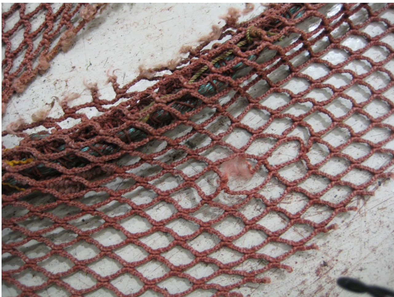
Figur 11: Bruddflatene i riftene ligner på skaden man får ved maskestyrketest (tatt midt i bildet).
