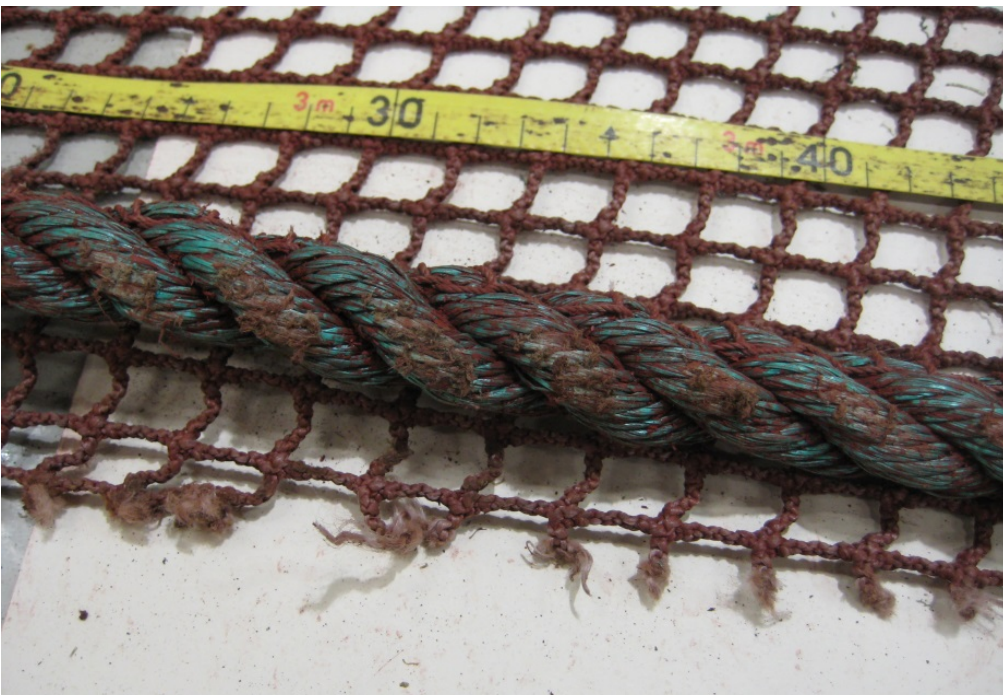
Figur 8: 330 cm nedenfor øvre ende av den store riften. Her endrer riften horisontal posisjon (maske) i notlinet.
