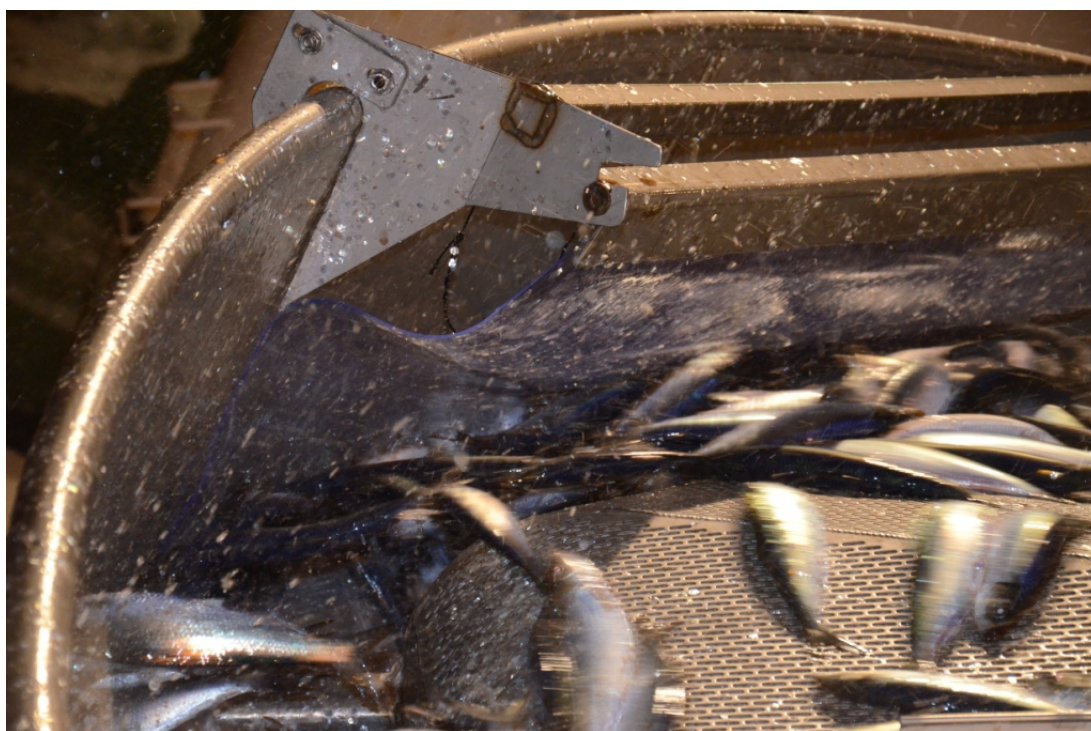
Foto 5.2: Dempegardinen i ytterveggen av silkassen. Denne er ment å dempe fisken idet den har passert avsilingssonen. Denne dempegardinen fungerte ikke tilfredsstillende.
