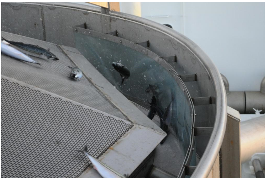
Foto 5.1: Dempegardin som fungerte godt. Denne er ment å dempe fisken i det den har passert avsilingssonen. Montert på babord side hvor det gikk lite fisk på grunn av at båten krenget til motsatt side.
