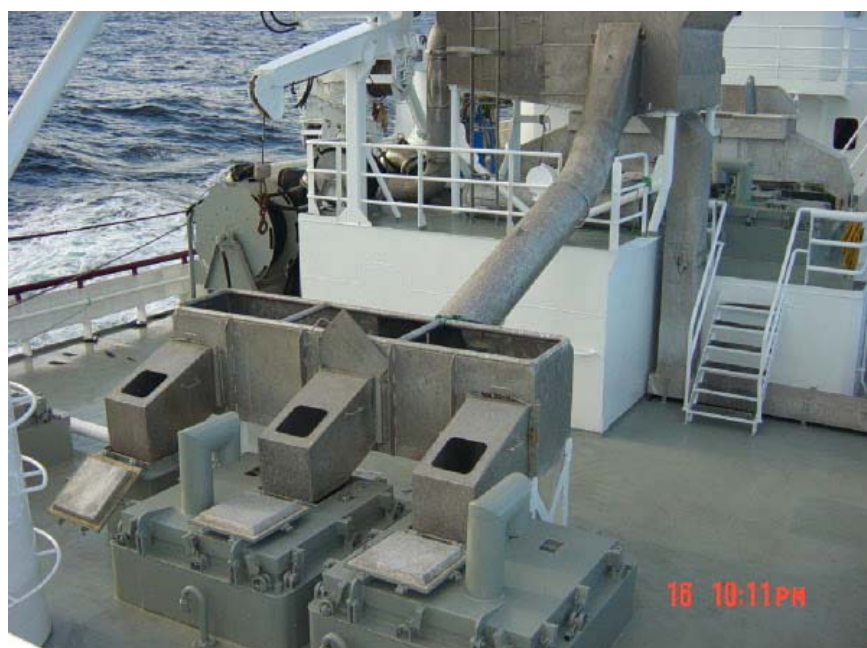
Bilde 3 Fordelingskasser fremst og bakerst i bildet. Silekasse i midten.
