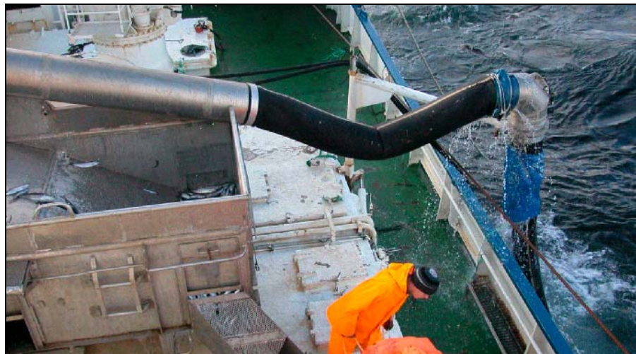
Bilde 11 Kombinasjon av fiskeslange og aluminiumsrør. 90° bend.
