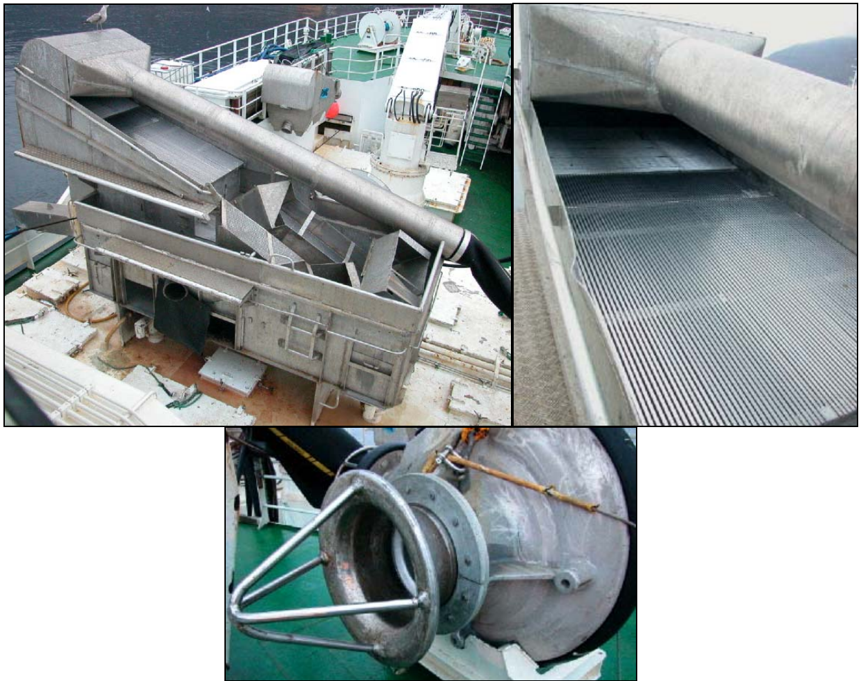
Bilde 2 Øverst vises Silekasse og dens rist. Under: Pumpe.
