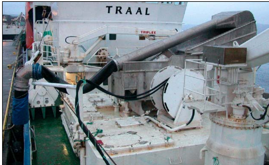
Bilde 10 Silekasse/rist med buffere under hvor fisken blir fordelt via renner til tankenes innløp.
