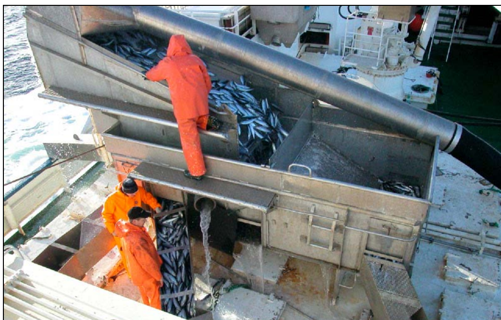
Bilde 3 Silekasse og renner. Silekassen brukes også til fordeling mellom tankene.
