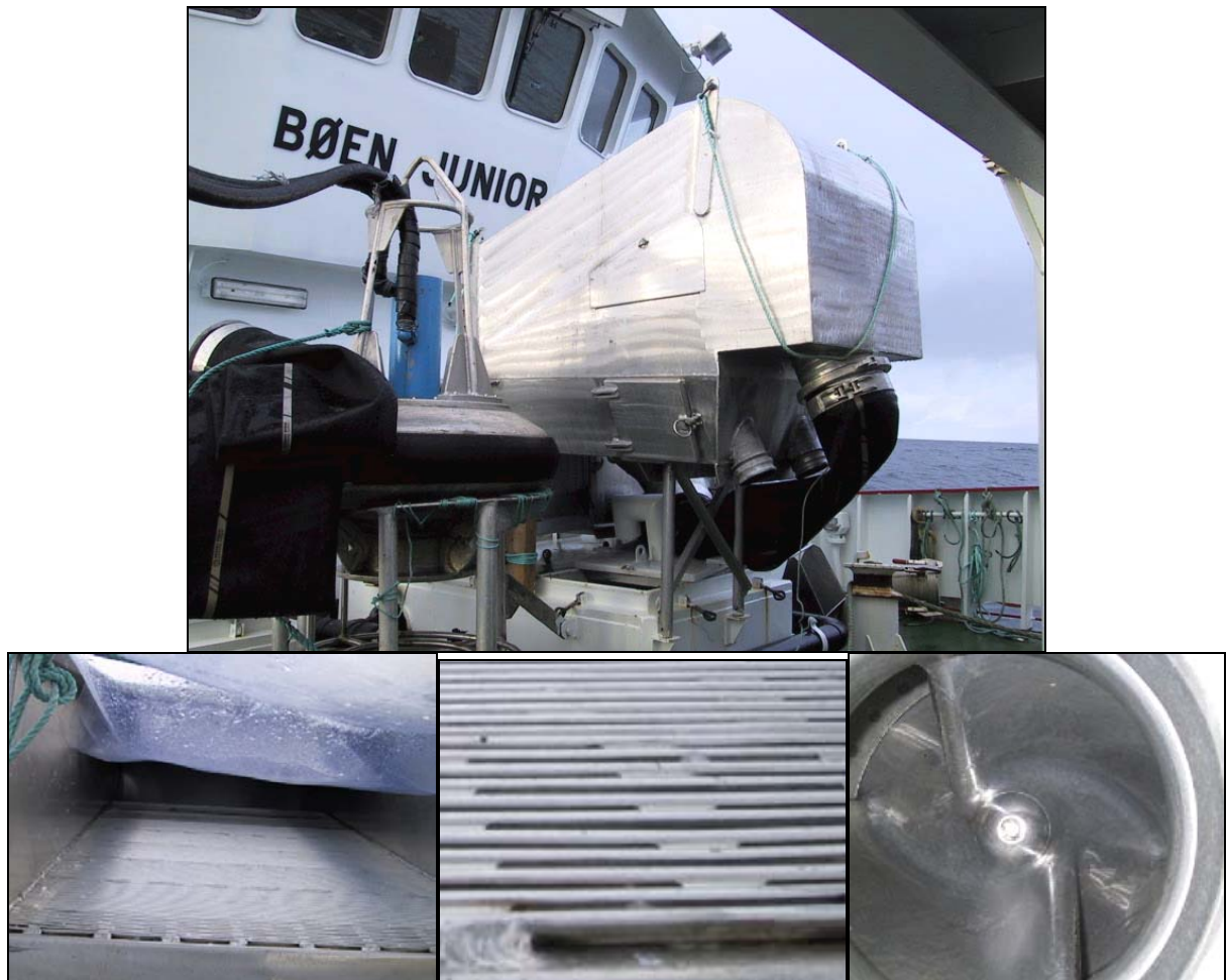
Bilde 2 Øverst: Silekasse og pumpe. Under: risten inne i silekassen som har avrundede spiler og pumpens skovler.
