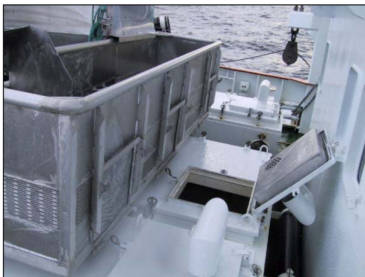
Bilde 7 Plassering av luke gjør at fisken går i skottet før den lander i vannet i tanken.
