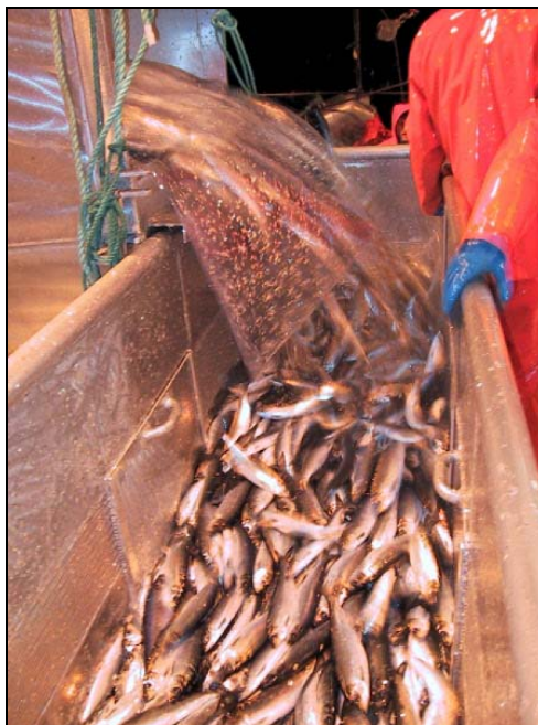
Bilde 6 Fallhøyde fra silekasse til fordelingskasse. Fisken støter mot veggen i fordelingskassen.
