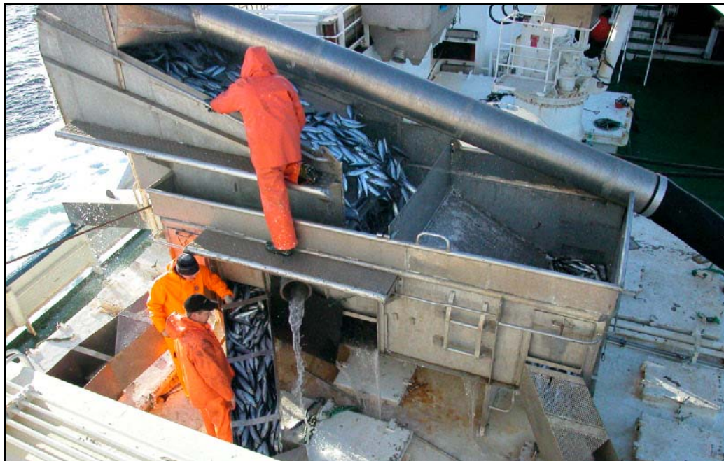
Bilde 4 Silekasse og renner. Silekassen brukes også til fordeling mellom tankene.
