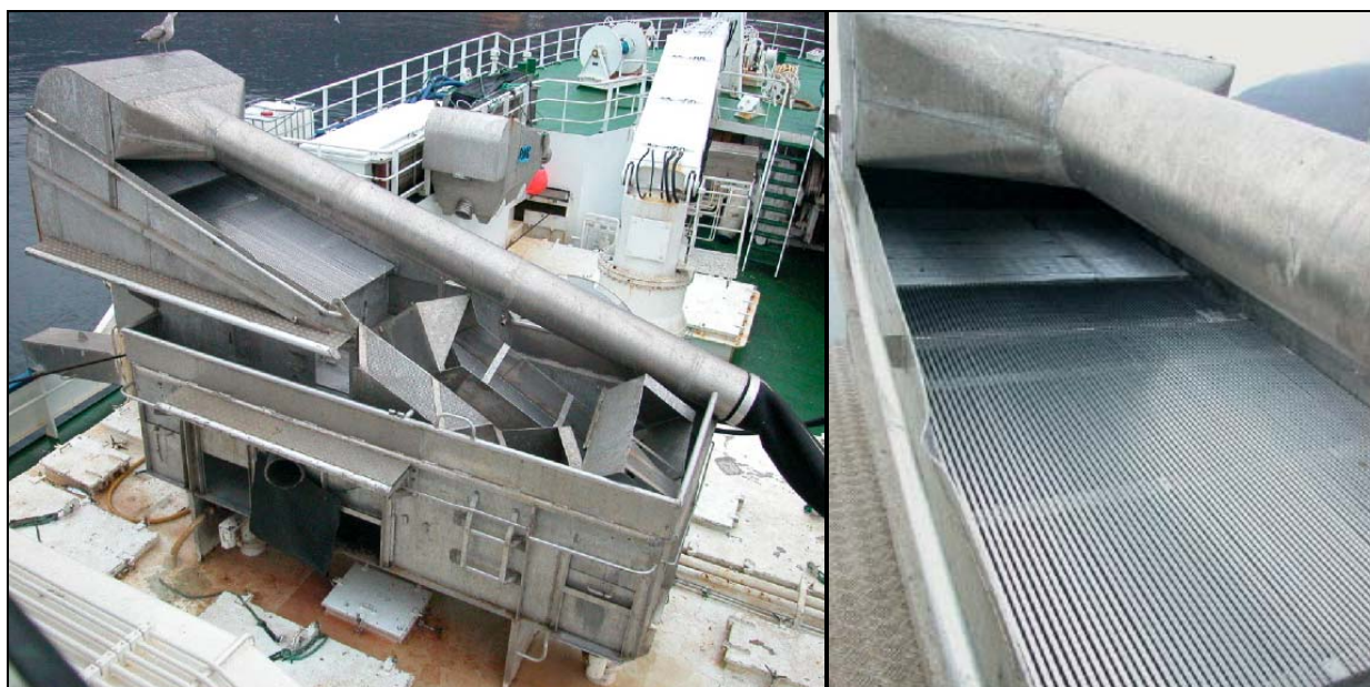
Bilde 2. Oversiktsbilde av silekassen og rist ombord på M/S Traal
