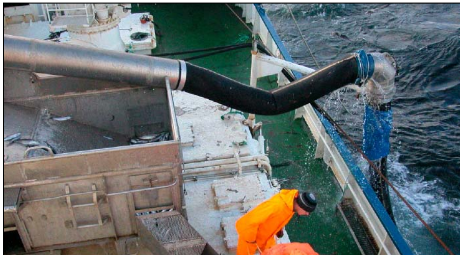
Bilde 11 Kombinasjon av fiskeslange og aluminiumsrør. 90°bend.
