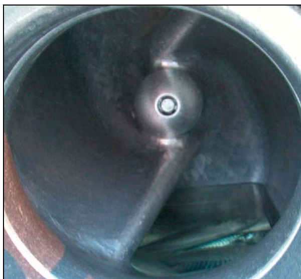
Bilde 12 Makrell ligger igjen i fiskepumpen etter at den er satt på dekk.
