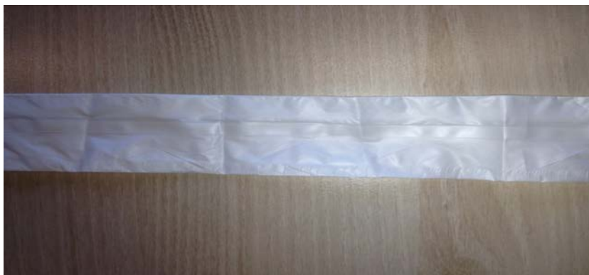
Figur 5: Bionedbrytbar film (Modefa BIO8), produsert for testing av restrukturert agn, er basert på en polymer som består av 'polyactide/poly-lactic acid' (PLA).
