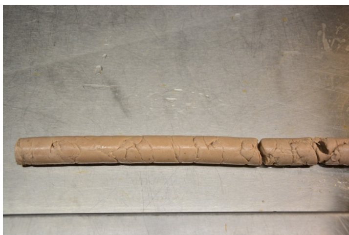
Figur 17: Eksempel på gelet agnc-pølse. Vi ser at pølsen hadde områder med flakdannelse og i enkelte tilfeller hadde de også spalter. Muligens skyldes dette forhold knyttet til doseringen av kalsiumklorid til agnc-massen.
