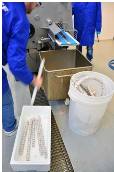
Figur 16: Agnc-pølser tatt ut fra TSCA 120 Poly-clip som er en maskin som sveiser, fyller og klipper pølsene i ønsket lengde. Pølsene ble lagt i esker for geling.
