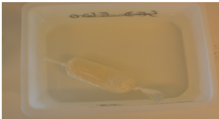
Figur 6: Permeabilitetstest for den bionedbrytbare filmen Modefa BIO8. En alginatløsning ble fylt i filmen som ble knyttet sammen i endene. 'Pølsen' ble lagt i en kalsiumkloridløsning. Ingen geling ble observert.
