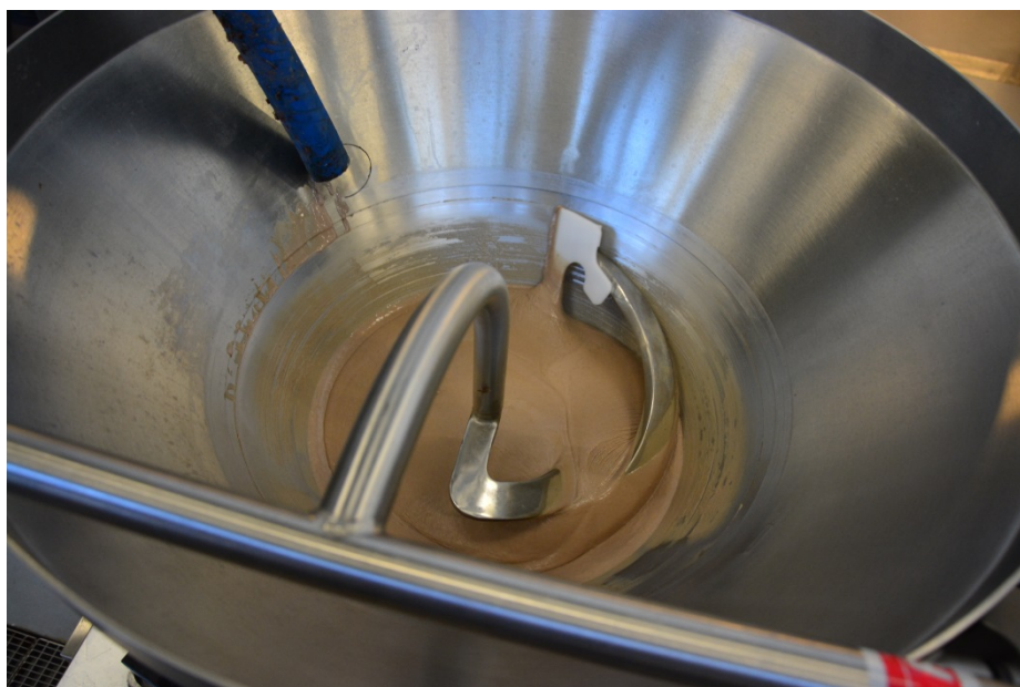
Figur 15: Agnmassens konsistens etter blanding og homogenisering. Bildet viser det traktformede innløpet (buffer) til Frey Maschinenbau F-Line F160 som er en enhet for automatisk styring av dosering av agnmasse.
