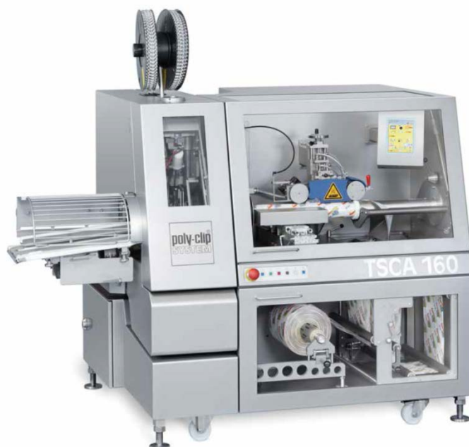
Figur 12: TSCA 120/160 Poly-clip for automatisert sveising, fylling av agnmasse og klipping av agnrørler. Nederst i maskinen ser vi rullen med film for sveising og pakking av rørler.
