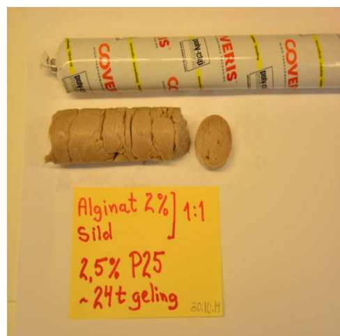
Figur 17: Eksempel på gelet agnc-pølse. Vi ser at pølsen hadde områder med flakdannelse og i enkelte tilfeller hadde de også spalter. Muligens skyldes dette forhold knyttet til doseringen av kalsiumklorid til agnc-massen.
