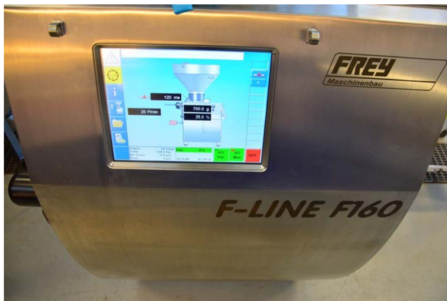
Figur 11: Frey Maschinenbau F-Line F160 sørger for buffring og automatisk dosering av agnmasse før tilsats av kalsiumklorid, fylling, sveising og klipping.
