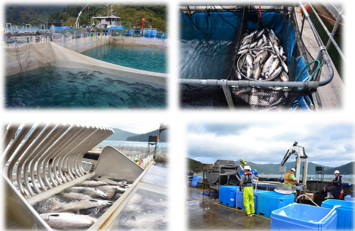
Figur 5 – Slakting ved en av New Zealand King Salmon sine oppdrettslokaliteter i Marlborough Sounds-regionen. Bildene viser skånsom trenging av fisk (øvert til venstre) og håving av laks bedøvd med AQUI-S™ (øvert til høyre). Bevisstløs fisk avlives ved bruk av en SI-5 slagmaskin før utmatning (bilde nederst til venstre) til manuell bløgging. Deretter pakkes fisken i is tilsatt noe sjøvann (nederst til høyre). Fisken bringes i land og transporteres videre med bil til prosesseringsanlegget i Nelson.
