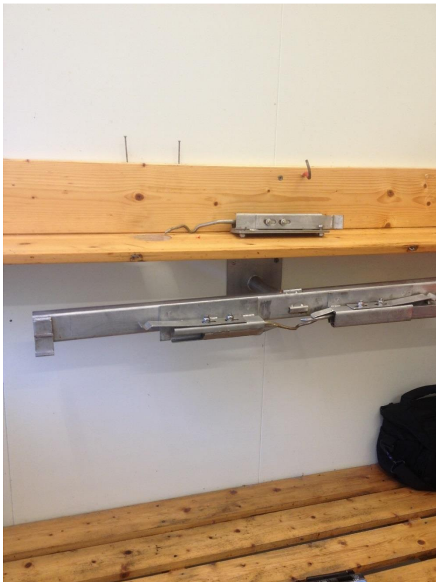
Figur 3. Original egnestasjon med veggmontert magasinholder.
