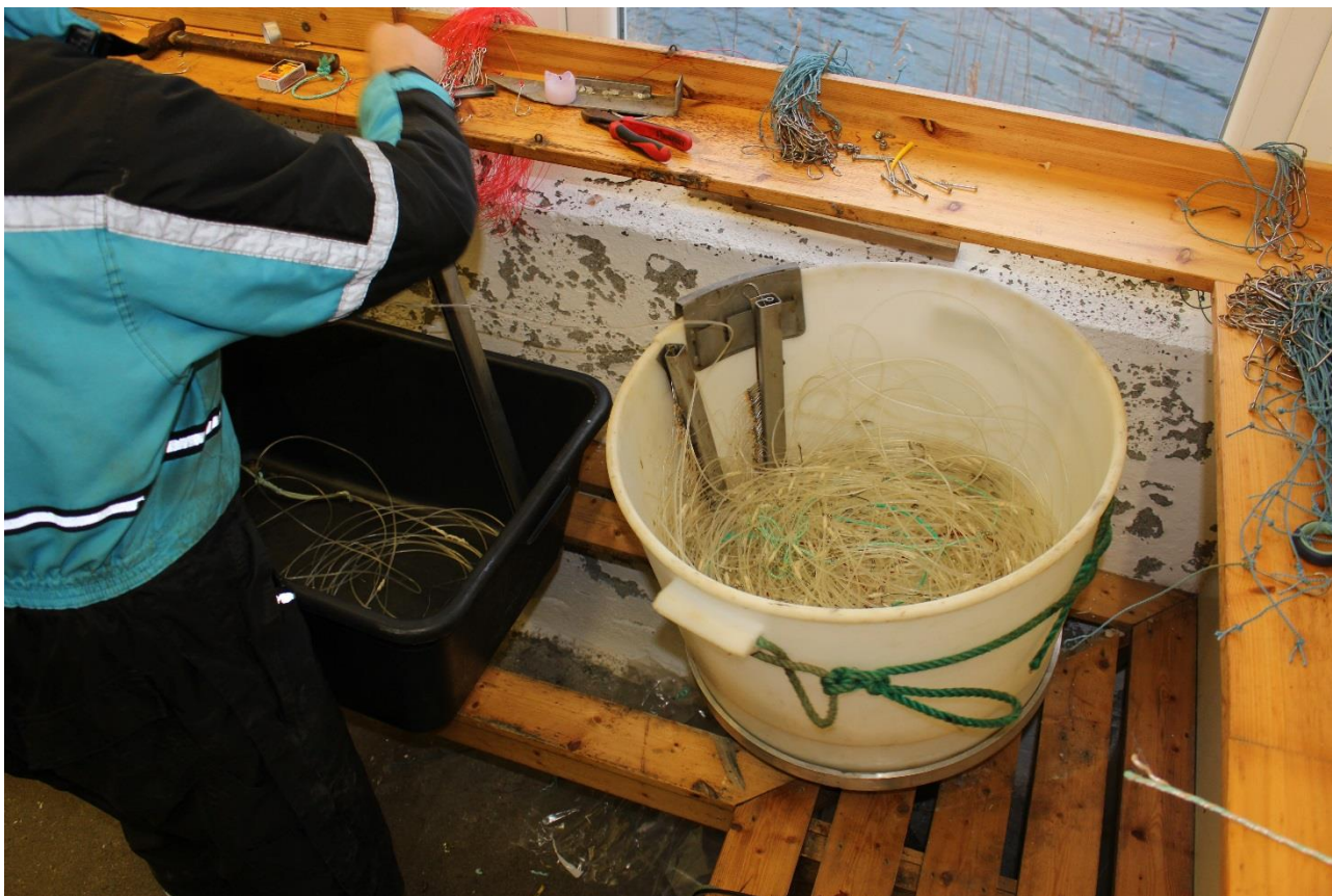
Figur 4. Halt stamp med korte magasiner og magasinholder. På dette bildet egnes ikke lina, men klargjøres for setting gjennom egnetrakt.
