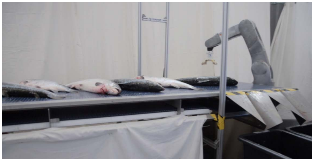
Figur 5-8; Utklippsbilde av videoen som demonstrerer robot som singularerer og orienterer laks i 4 posisjoner.
