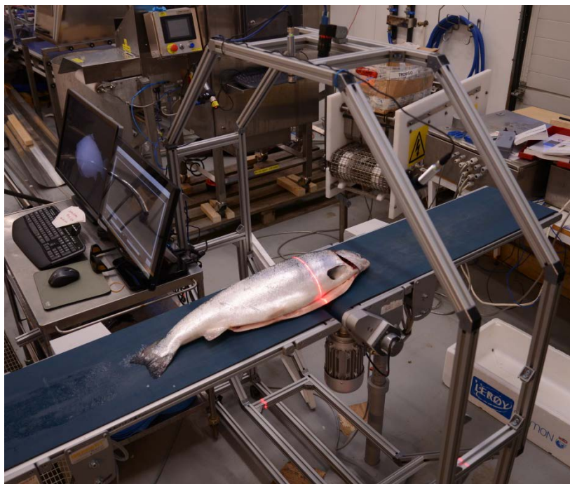
Figur 5-15; Oppsett av rigg for laserbelysning og avbildning i 120°.
