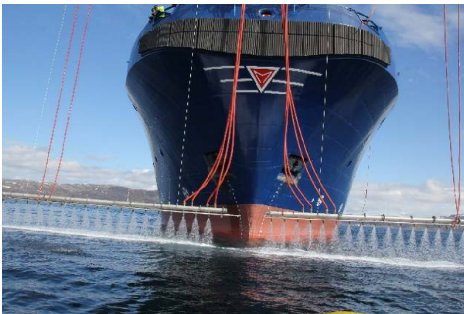
Figur 5-2 Manifold (baugbom) med dyser for høykapasitet vanddosering for mekanisk dispergering - installert foran på fartøyet.
