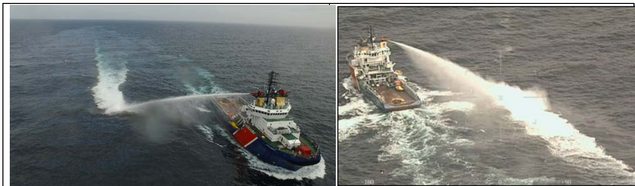
Figur 6-3 Vanndosering fra FiFi-monitor på MS Strilborg (dronevideo ved Maritime Robotics og ©Finnish Border Guard / SYKE (Daling et al., 2017).
