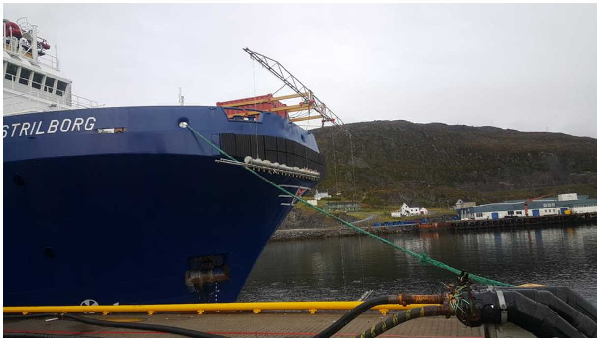
Figur 1.2 Anlegget sett fra kai rigget opp med manifolder og opphengsarmer i fremre posisjon, god posisjon for dispergering langt fremme foran baugen.
