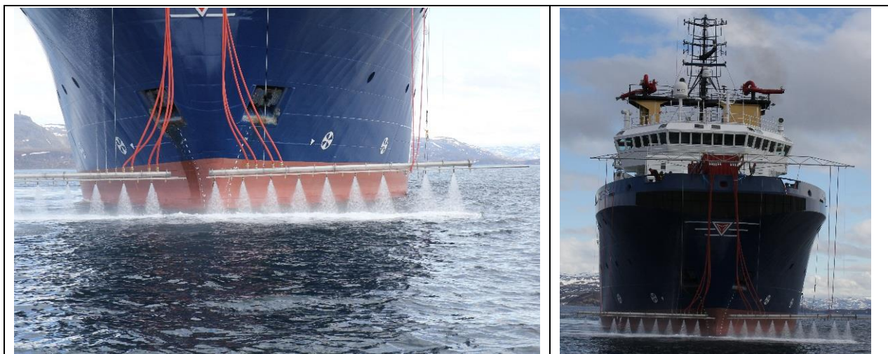
Figur 6. Spraymønster av hele systemet, 19 dyser, testet opptil 10 knops fart.
