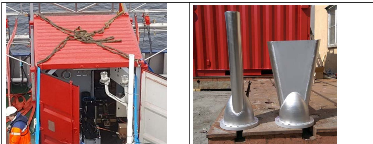
Figur 4-1 Venstre: Konteiner basert system for både mekanisk - og kjemisk dispergering. Høyre: Deflektordyser.
