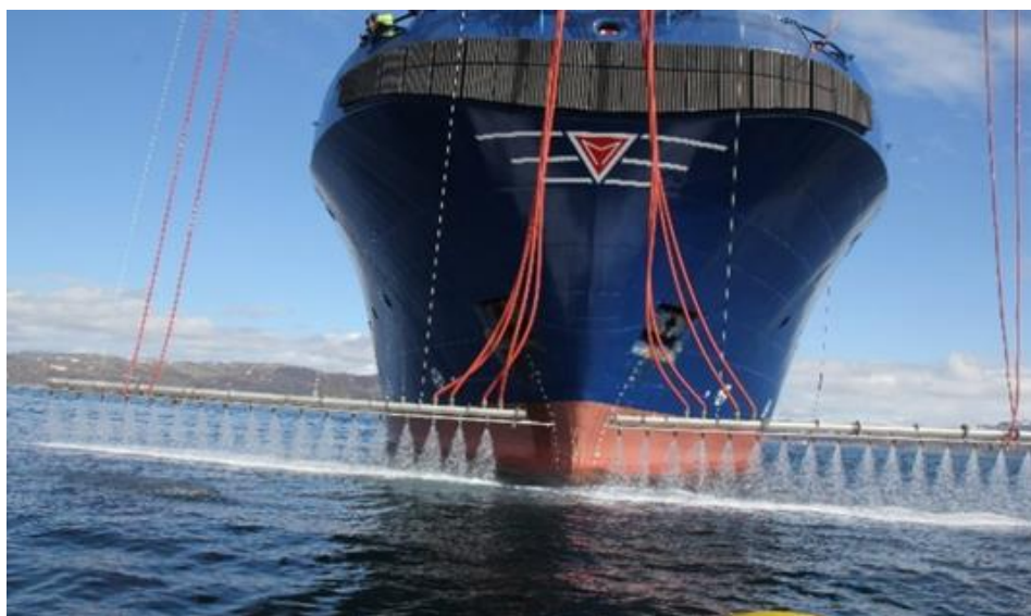
Figur 1.6 Høykapasitet dysebom installert på MS Strilborg (fra Sjøtest i Hammerfest mai, 2016).
