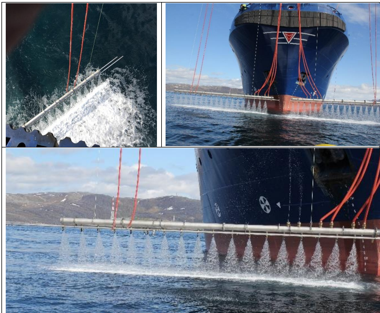
Figur 5. Spraymønster av hele systemet, 38 dyser, testet opptil 10 knops fart.
