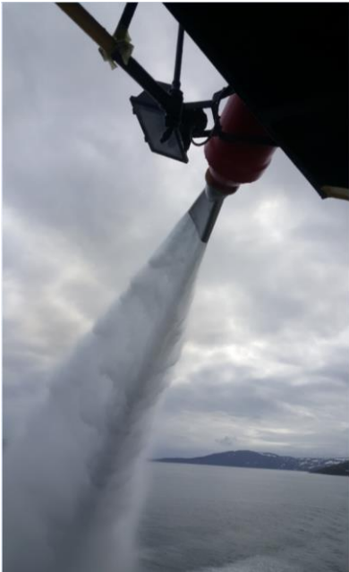
Figur 2.4 Deflektordysen (nebbet) - Deling av vannstrålen som ikke ga ønsket effekt.
