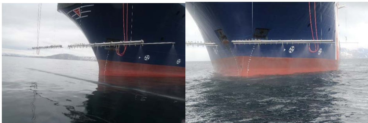
Figur 5-3 Spraymønster av dispergeringsbom (høy og lavdosering, sett fra MOB båt).
