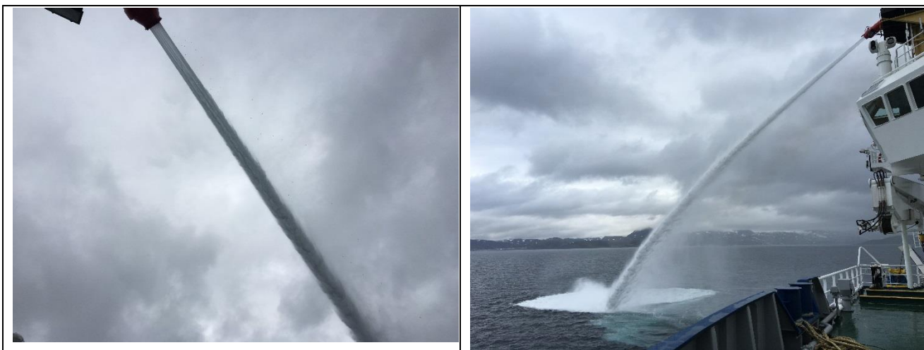
Figur 12. Spraymønster på Fi-Fi monitor uten deflektor, nedslagsfelt ca. 50 m fra skutetida.
