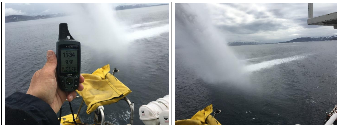
Figur 4. Nedslagsfelt av deflektor montert på Fi-Fi monitor, testet opptil 10 knops fart.
