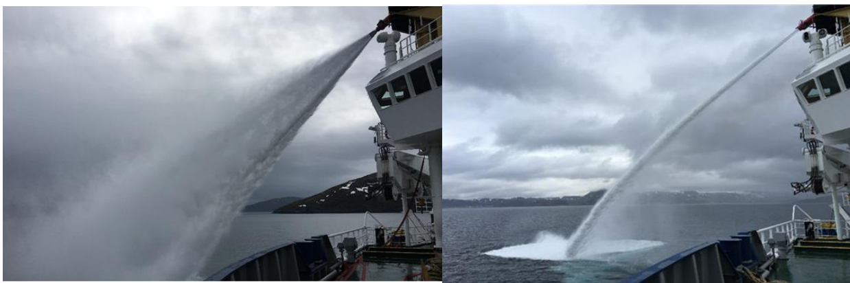
Figur 2.3 Sjøtesting i Hammerfest mai, 2016. Testing med installert deflektor (venstre) og uten deflektordyse (høyre).
