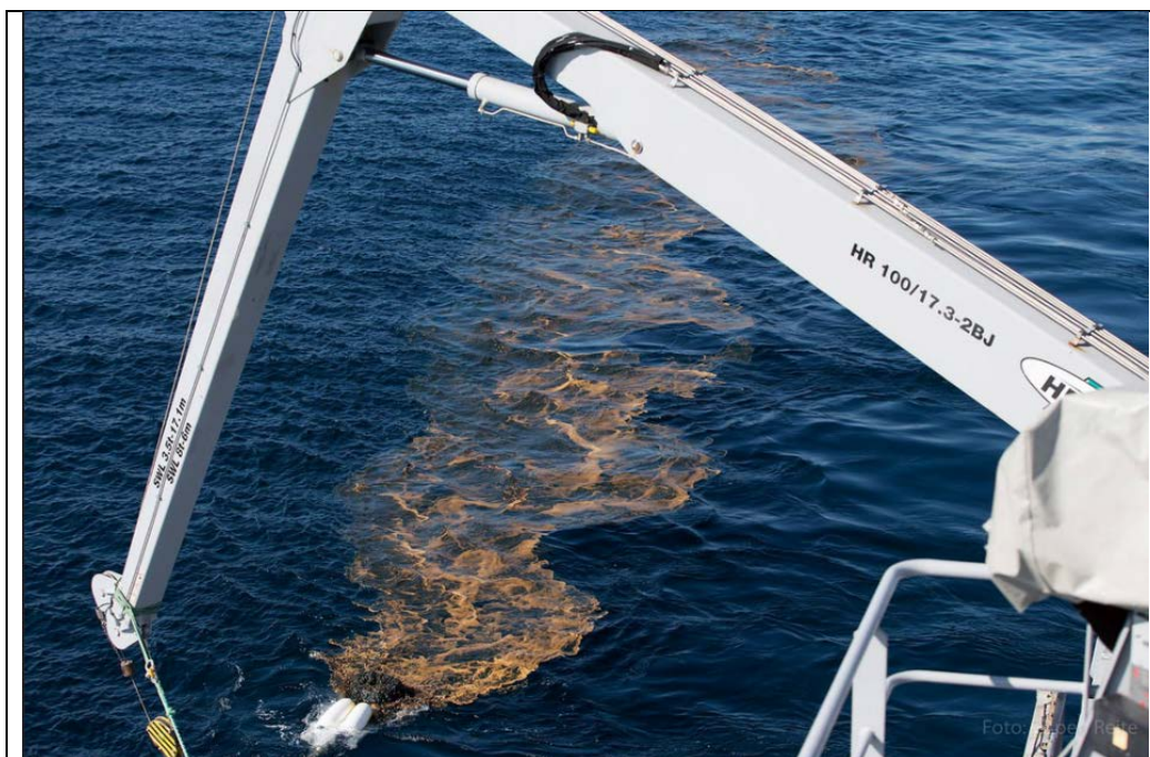
Figur 6-1 Utslippsarrangement for utslipp av Åsgard Blend fra KV Sortland fra feltapport gitt i Daling et al., 2017.
