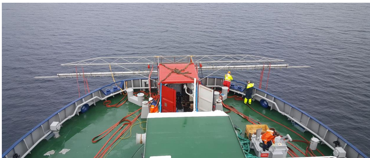
Figur 1.1 Konteinerbasert dispergeringsutstyr (baugmontert dysebom for både høykapasitet vanddosering og dispergeringsmanifolder for høy og lav-dosering av dispergeringsmiddel) oppstilt på MS Strilborg klar til bruk.
