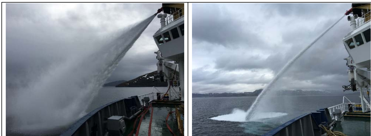
Figur 5-1 Venstre: Spraymønster av deflektordyse montert på FiFi monitor med todeling og redusert vannstråle. Høyre: Spraymønster på FiFi-monitor uten deflektordyse med et nedslagsfelt ca. 50 m fra skutensida.
