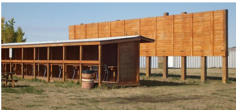
Figur 12 Uheldig utforming av horisontalblender. Denne vil gi kraftig refleksjon og forsterke lyd bakover og til sidene
