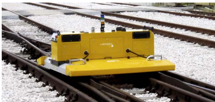
Figur 11: Inspeksjonsrobot og eksempel på måleresultat ©2014 Loccioni Group
