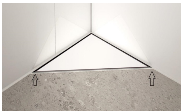
Figur 1a og b: Firesidig fall (til venstre) er utfordrende i kombinasjon med store fliser. Plasseres sluket i hjørnet (til høyre) kan man greie seg med en eller tosidig fall.
