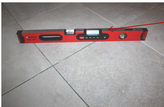
Figur1: Omregning fra % viser at flaten med 1,64 % helning tilsvarer fallforhold ca 1:60
