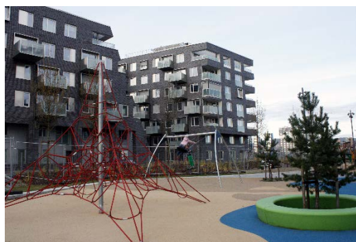
Fig. 26 Universelt utformet lekeplass. Her er det valgt et fast, men likevel mykt dekke, slik at rullestolbrukere kan sirkulere og fall ikke får store konsekvenser.
