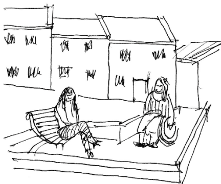
Fig. 25 Kravet til universelt utformet uteareal i TEK10 forutsetter bare et flatt parti på størrelse med et hvilerepos ved en sittegruppe eller annet areal opparbeidet til uteopphold.
