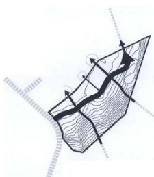
Fig. 49 Kjøreveien er ført langs kotene. Gangstier går på tvers av kotene.
