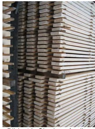
Bilde 12. Skurlast, ferdig tørket. Foto: Kjersti Folvik
