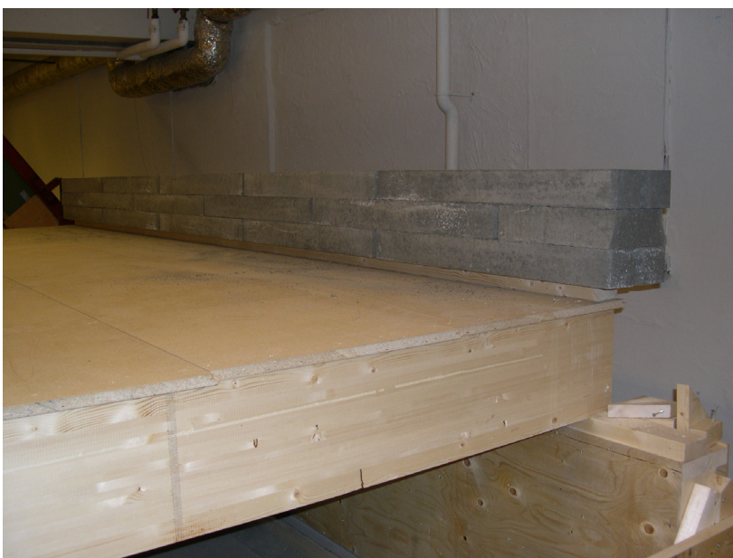
Figur 4.1 K-bjelkelag i laboratorium, med randlast på opplegg
