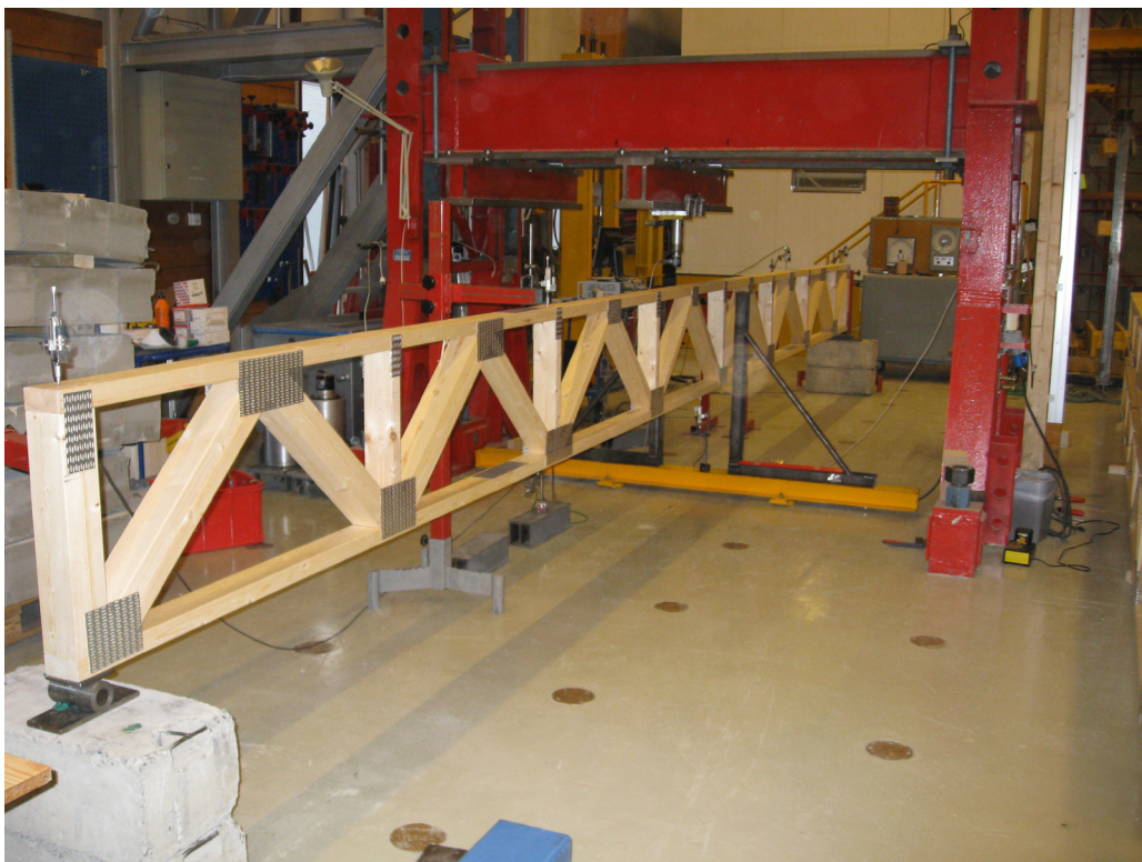
Figur C-1 Måling av bøyestivhet til gitterbjelke ved SINTEF Byggforsk sitt laboratorium i Oslo
