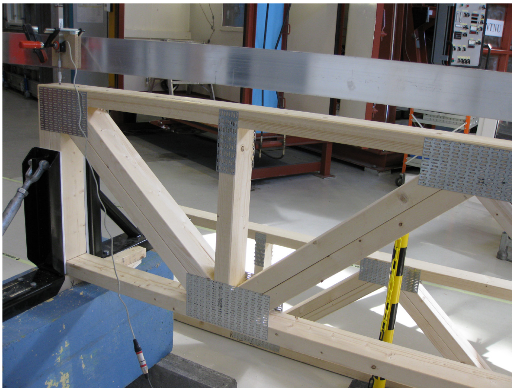
Figur C-2 Rigg for måling av nedbøyning under punktlast og dynamiske egenskaper til enkeltbjelke. Opprigging i SINTEF Byggforsk sitt laboratorium i Trondheim
