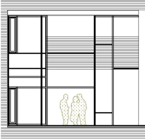
Figur D-14. Vindusmodul, trappehus
