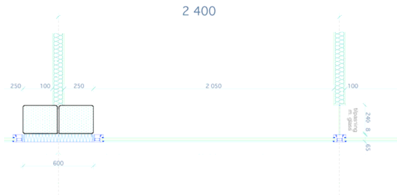
Figur A-5. Horisontalsnitt gjennom vindu.
