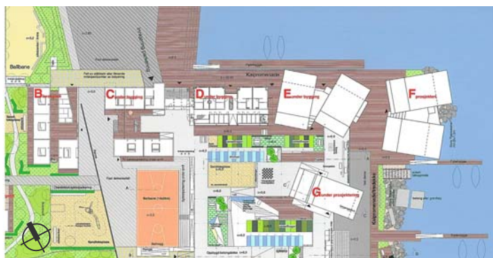
Utomhusplan ved B ferdigstilt. Bygg B, C og D er modulbyggeri. E, F og G er plassbygd. "Aktivitetssone" mellom C, D, E, F og G under ferdigstilling.
