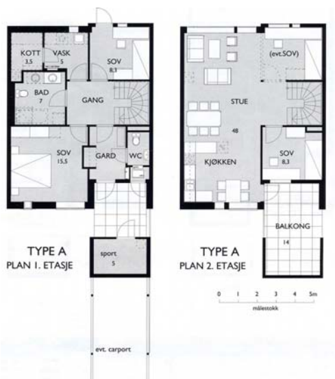
Harald Sæveruds vei, Bergen. Bod og carport danner en skjerm for en privat uteplass ved inngangen. Denne er overdekket av balkongen i 2. etg. Arkitekt: Mette og Morten Molden.
