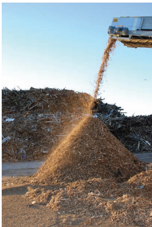
Foto 1.1: Bearbeiding av avfallsvirke, Solør gjenvinning. Foto: Kjersti Folvik
