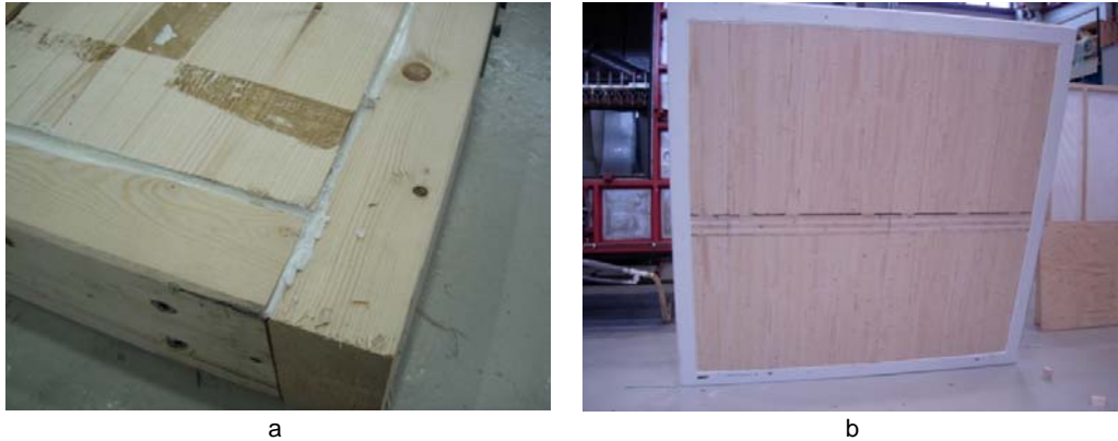
Fig 4.1 Prøvefeldet montert i en ramme med kantbjelker med dimensjon 48 mm x 98 mm (a). Prøvefeldet ble satt inn i en stålramme som ble montert mot luftskapet (b).
