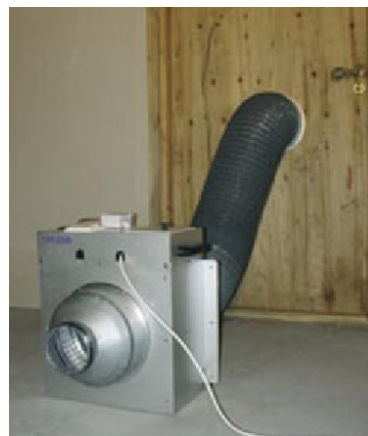
Figur 7-2 Lekkasjemåleutstyr fra Flexit AS
