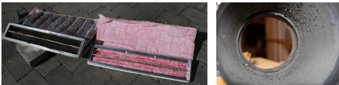
Figur 2.5-3 Brukt (ett år) og nytt posefilter. Innvendig side av inntakskanal etter 7 års drift
