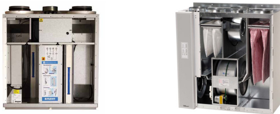
Figur 2.5-1 Eksempler på moderne ventilasjonsaggregater for småhus. Begge med roterende varmeveksler, energieffektive EC vifter og bypass for tilkobling til komfyravtrekk. Flexit (venstre) og Systemair (høyre)
