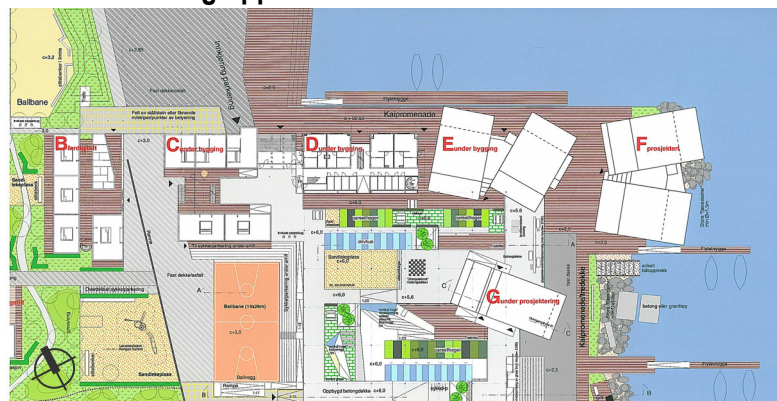
Utomhusplan ved B ferdigstilte. Bygg B, C og D er modulbyggeri. E, F og G er plassbygd. "Aktivitetszone" mellom C, D, E, F og G under ferdigstilling.
