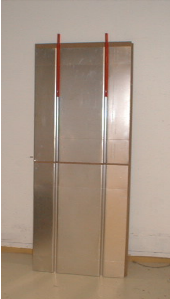
Fig. 3.2. For å forenkle monteringen og øke dekningsgraden av varmfordelingsplater over gulv og takflaten er det brukt en type profil aluminiumsplater for 2 rør med røravstand 300 mm. Varmefordelingsplatene er limt til porøse trefiberplater. For ytterligere å øke dekningsgraden for varmfordelingsplater over heteflaten bør man også kunne utnytte varmeavgivelsen fra rørsøyfene. Det er derfor viklet utvendig Al-folie rundt røret i rørsøyfene med en overliggende 0,5 mm tykk Al-plate.
