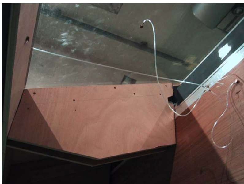
Figur 11 Plassering av trykkslanger på tre steder i raftet.
