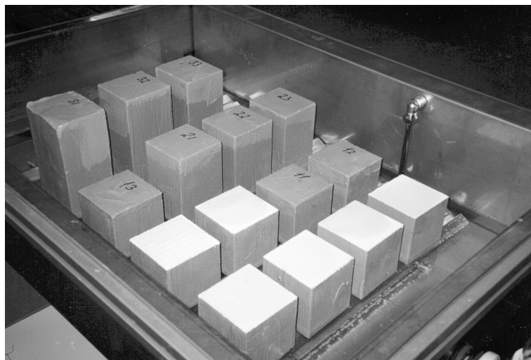
Figur 12 Eksempel på prøvestykker delvis nedsenket i vannbad
