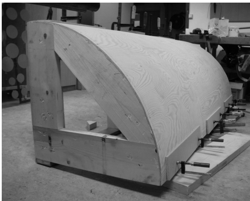
Figur 12 Produksjon av snøspylere (foto: T. Thiis, NBI)
