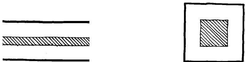
Fig. 2.1i-3: Prinsipp-plan. Bygningsbredden kan økes når lengden reduseres. Mørkt kjerneareal og avstand til yttervegg er det samme i begge eksemplene (hvh. 16 og 25m).
