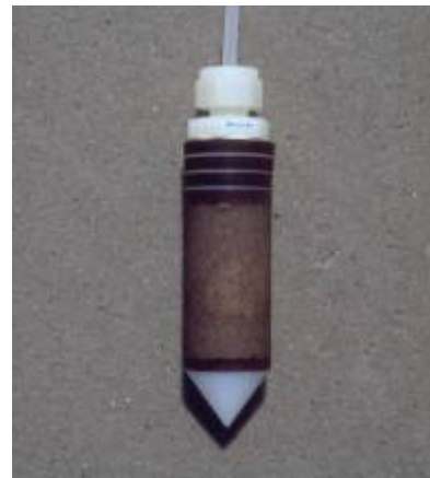
Figur 4 Væskebeholdere og pumpesystem med vakuumbstyring, og et Prenart lysimeter.
