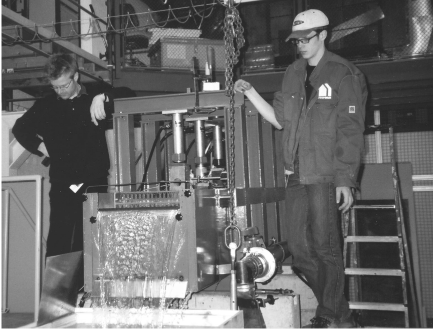
Figur 5 Prøveoppstilling med prøvekasse sett forfra ved overløp
