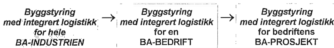
Fig. 11. Byggforsk systemmodell for byggstyring gir en ramme for å utvikle bedriftens styringssystem. Her integreres logistikk i bedriftens styring av dens oppgaver innen bygge- og anleggsprosjekter.
