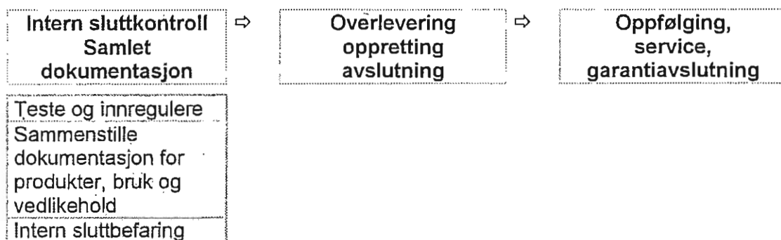
Fig. 38. Før intern sluttbefaring må all innregulering være avsluttet og all dokumentasjon være samlet.
