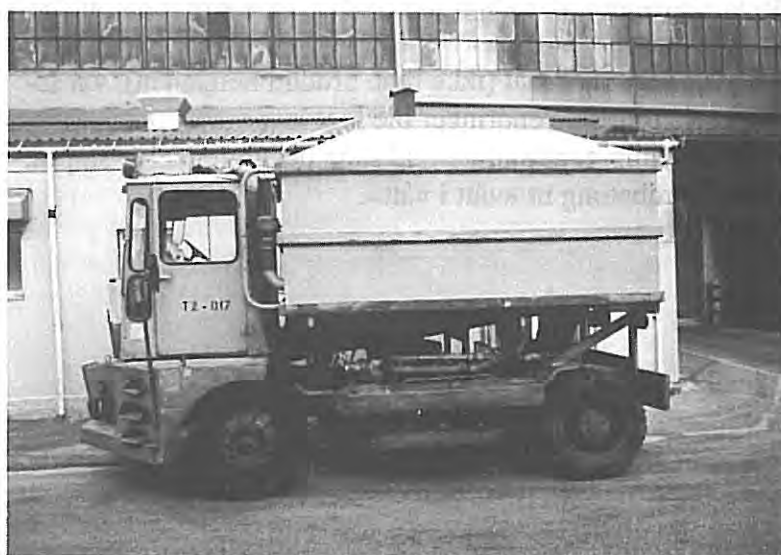
Fig. 8.3 c Lastebil hvor akseltrykket med last kan bli opp mot 12 – 13 tonn
