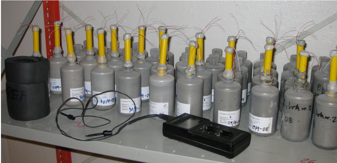
Figur 2.1.2 Plastflasker med sementpasta instrumentert med RF-sensorer av typen HumiGuard.
