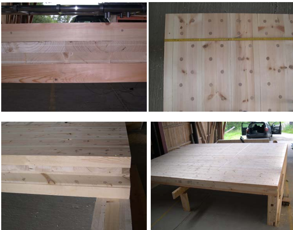
Figur 3.1. Bilder fra forsøksoppstilling med Holz100 elementer.
