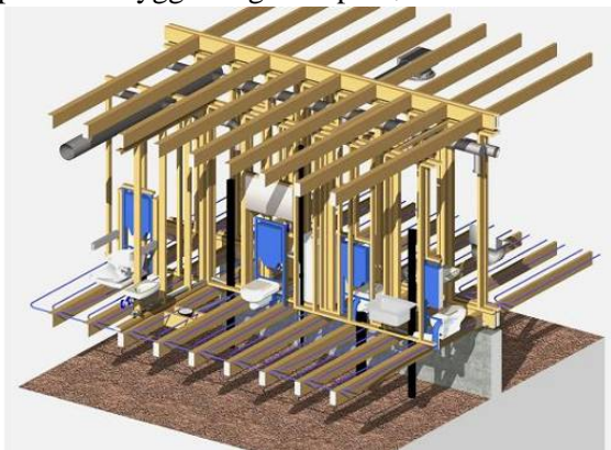
Figur 4.2.1. Bildet viser en illustrasjon av bæresystem og installasjoner i ArchiCAD (Kilde: Husfabrikken Steinkjer)
