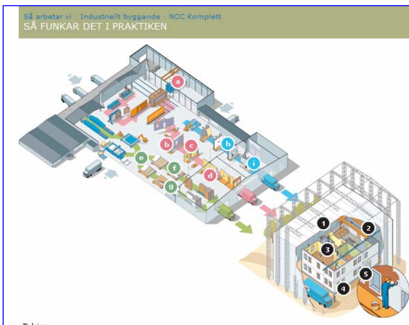
Figur 6.2.1 Prinsipp-skisse som viser produksjonskonseptet til NCC Komplet
