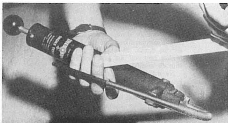
Fig. 10. Når det tas sotprøve av røyken, bør det helst ikke fremkomme slike svarte flekker som vi ser her.
