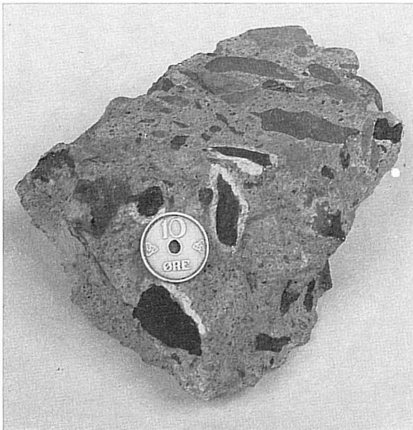
Fig. 2. Alunskiferkorn innstøpt i betong med karakteristiske reaksjoner av etringitt og gips.
