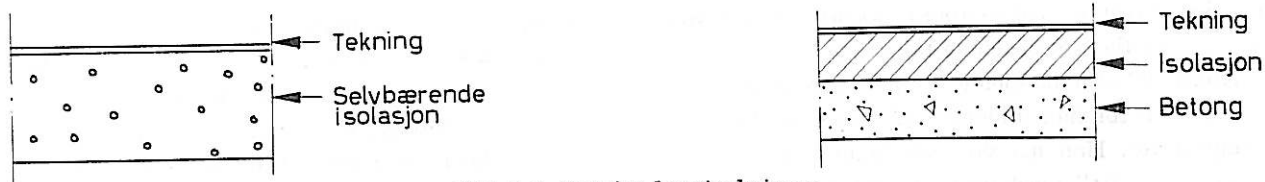
Fig. 5 a. Massive konstruksjoner.
