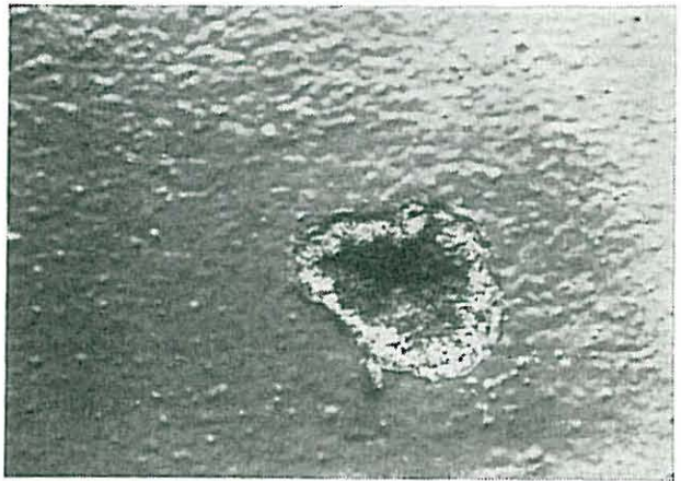
Fig. 1. Typisk krater etter kalksprett.
