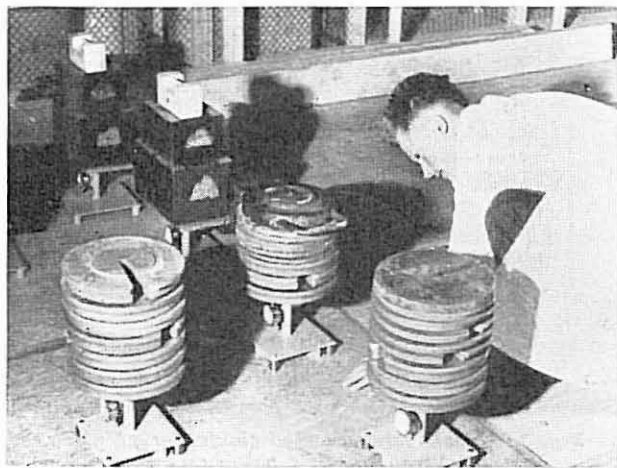
Fig. 2. Måling av golvbeleggs elastisitet og plastisitet.
